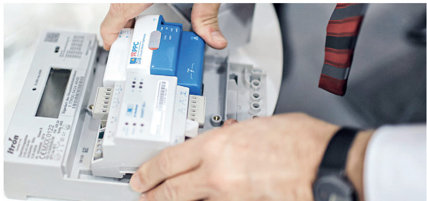
Intelligente Messsysteme liefern Daten für die Steuerung der Netze im Projekt PolyEnergyNet.
